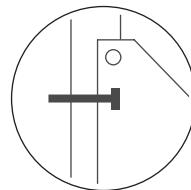
Asegúrese de apretar bien el tornillo en el cuerpo del mingitorio, únicamente sujeté en la parte posterior o respaldo del equipo.
