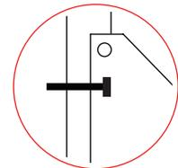
Asegúrese de apretar bien el tornillo en el cuerpo del mingitorio, únicamente sujete en la parte posterior o respaldo del equipo.
